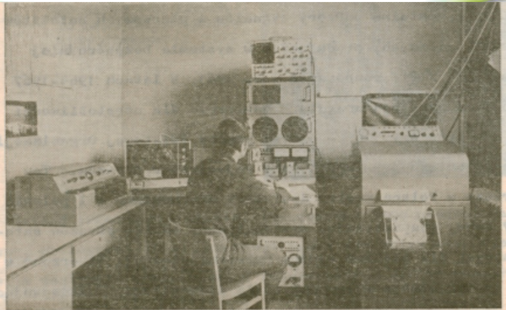
ys.24. Aparatura odbiorcza i rejestrująca pierwszej polskiej Stacji Odbioru Danych Satelitarnych /r.1968/
